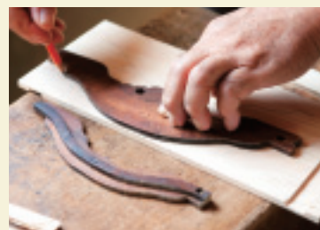
先代から受け継いだ型で各部品を製作
