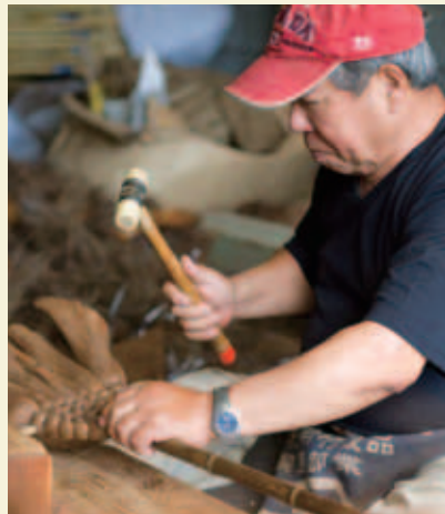
樹皮を組み上げ、しっかりと固定する
